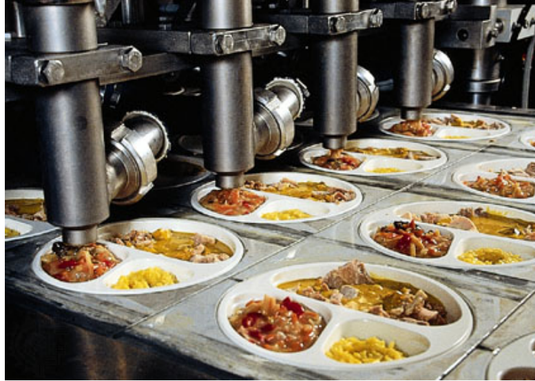
ภาพ 4.1 การบรรจุอาหารแบบอัตโนมัติด้วยเครื่องจักรกล ที่มา: Chompoonuch (2551)
