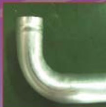
ภาพแสดงถึงปัญหา : การดัดปลายท่อหลังจาก Bending ดัดเอียง และไม่ได้นาน
